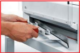
อุปกรณ์เปลี่ยนใบมีด ใช้งานง่ายป้องกันอันตรายจากใบมีด
